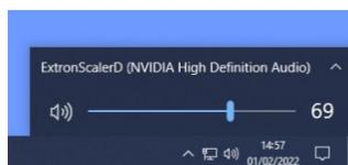
Avant de commencer le streaming avec diffusion en salle simultanée, c'est la **sortie audio ExtronScalerD (Nvidia)** qui doit être sélectionnée sur le PC fixe.
