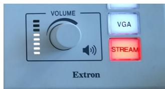
Pour lancer le streaming, il suffit d'appuyer le bouton **STREAM** présent sur la chaire, il clignotera en rouge. Attendre 30 secondes environ pour vérifier la diffusion en streaming.
