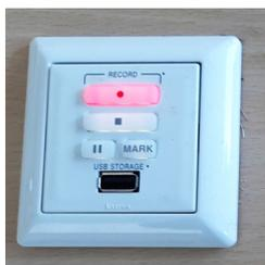
Il suffit d'insérer votre clé usb, et d'appuyer sur **●** pour lancer l'enregistrement et pour l'arrêter sur **■**.
